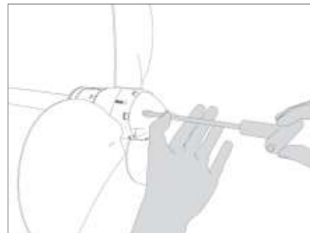
FIG. 20 Fixation de l'anode à l'aide des vis
