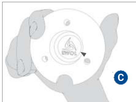
FIG. 36 Anode sacrificielle originale EWOL
