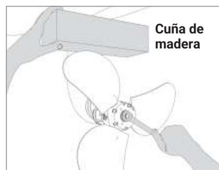
**FIG. 3** Bloqueo de rotación
