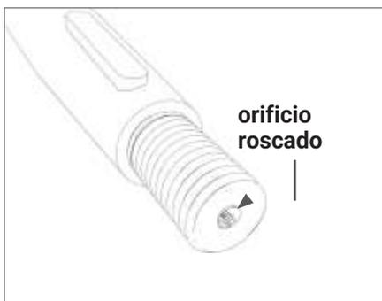
FIG.16 Perfore un orificio roscado en el eje, debe quedar perfectamente centrado y alineado
