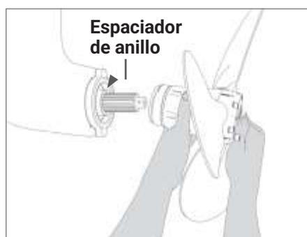
**FIG. 1** Inserción de la hélice en el eje Sail-Drive
