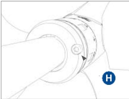
ABB. 29 Federklemmschraube „H“
